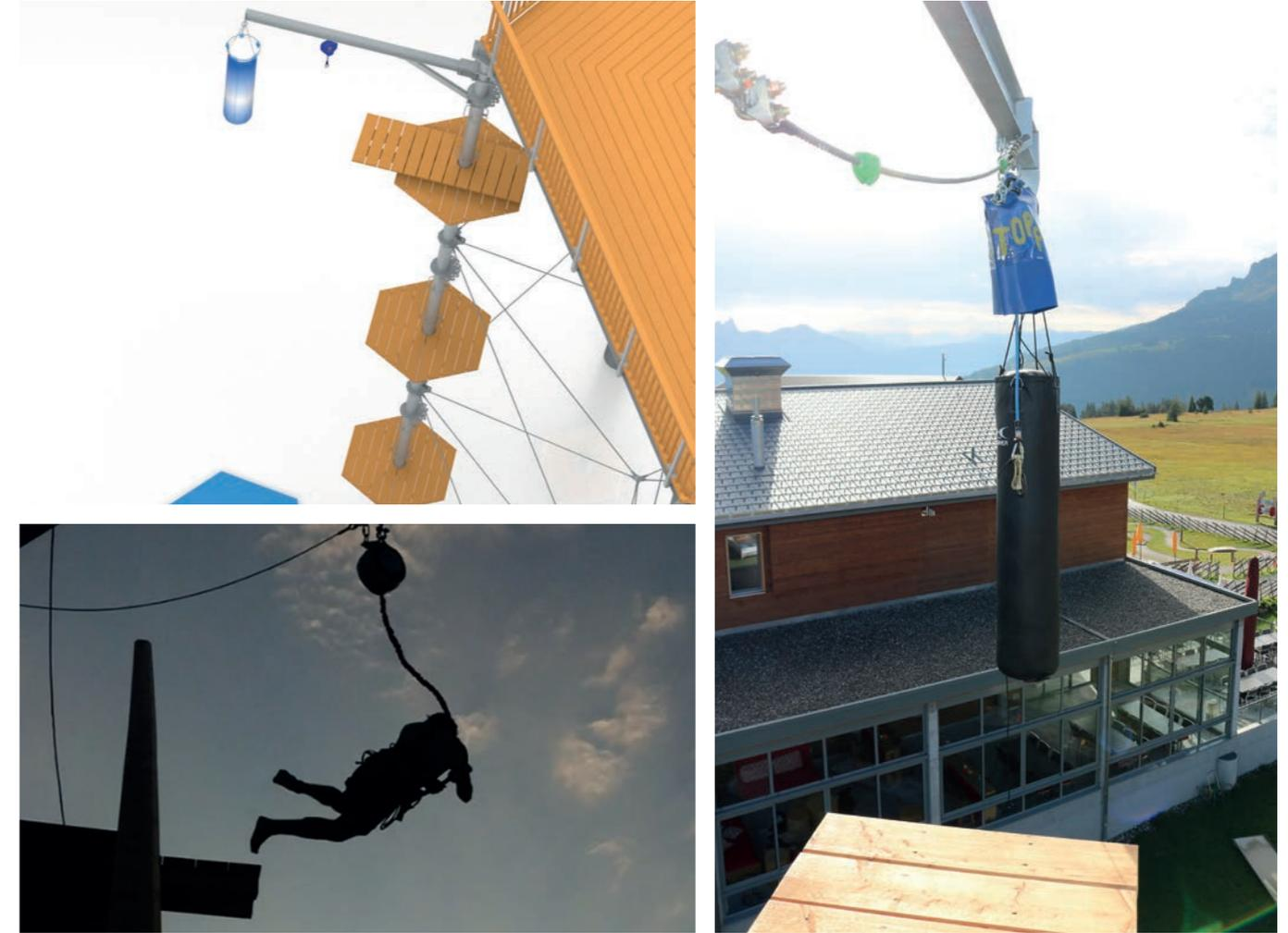
Beim Vertrauenssprung springt der Gast in Richtung eines Schaumstoffsacks und versucht sich daran festzuklammern, bis er durch das Sicherungsgerät TOPPAS sanft zu Boden gelassen wird. Die Herausforderung besteht darin, in seine eigenen Sprung- und Haltekräfte zu vertrauen und sich selbst zu überwinden. Das unterscheidet dieses Element von der gewöhnlichen Abseilstation.
