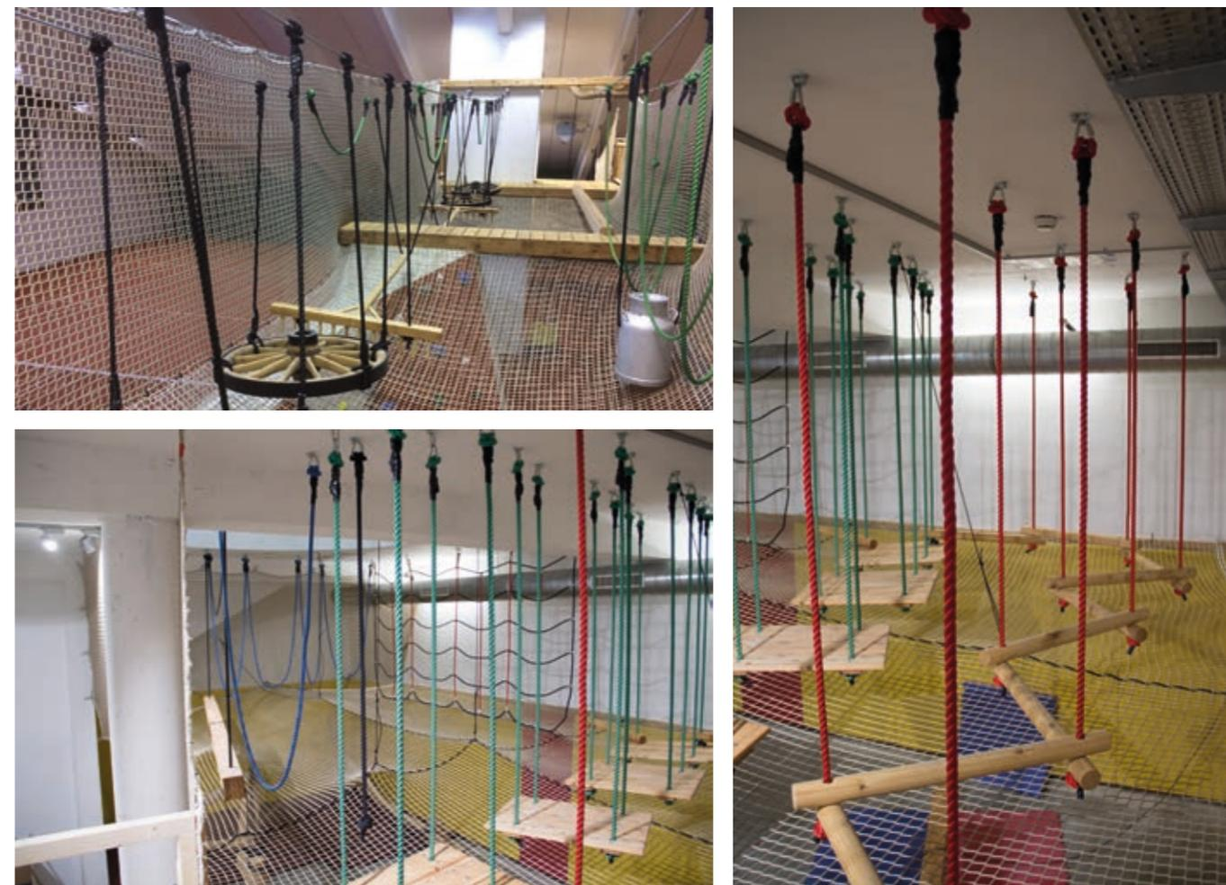
Der Netzparcours ist die ideale Lösung für die effektive Nutzung von hohen Räumen. Durch ihn kann der Spielbereich in mehrere Ebenen aufgeteilt werden und bietet so Platz für mehr Kinder gleichzeitig. Als Fallschutz werden Auffangnetze in geringer Höhe unter den Seilgartenelementen angebracht. Die Stationen können wie im Hochseilgarten thematisch gestaltet werden. Als Zu- und Ausgänge können beispielsweise Spieltürme mit Kletterwänden und Rutschen oder vorhandene Galerien und Emporen dienen.
